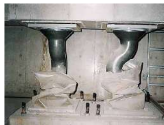
免震性能確認試験
