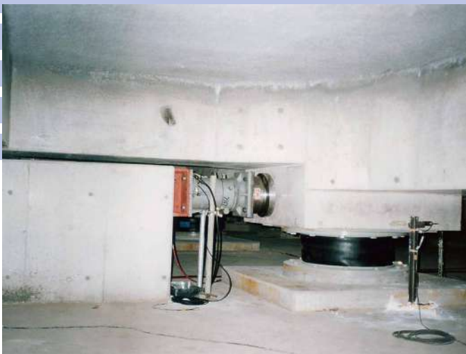
免震性能確認試験
