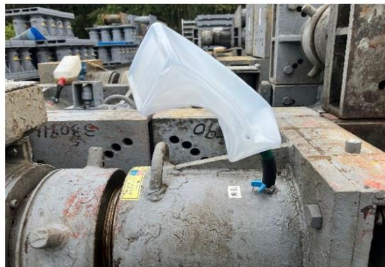
\* 解体時、オイルタンクが邪魔に、ならない様にジャッキカバーの中に取付ける
